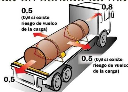
4. La **retención de la carga se consigue mediante la suma del rozamiento con el suelo**, sistemas de bloqueo, de amarre, resistencia de la propia carrocería... Las normas relativas a los vehículos que se relacionan en el anexo III son una referencia para el cálculo, en los tipos y casos en que proceda.
